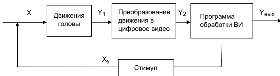
Рис. 2. Структурная схема системы виброизображения уравнивающего преобразования. Влияние стимулов на параметры ПФС. Прямое преобразование измеряемых величин аналогично рисунку 1 и показано в виде интегральных блоков преобразований
